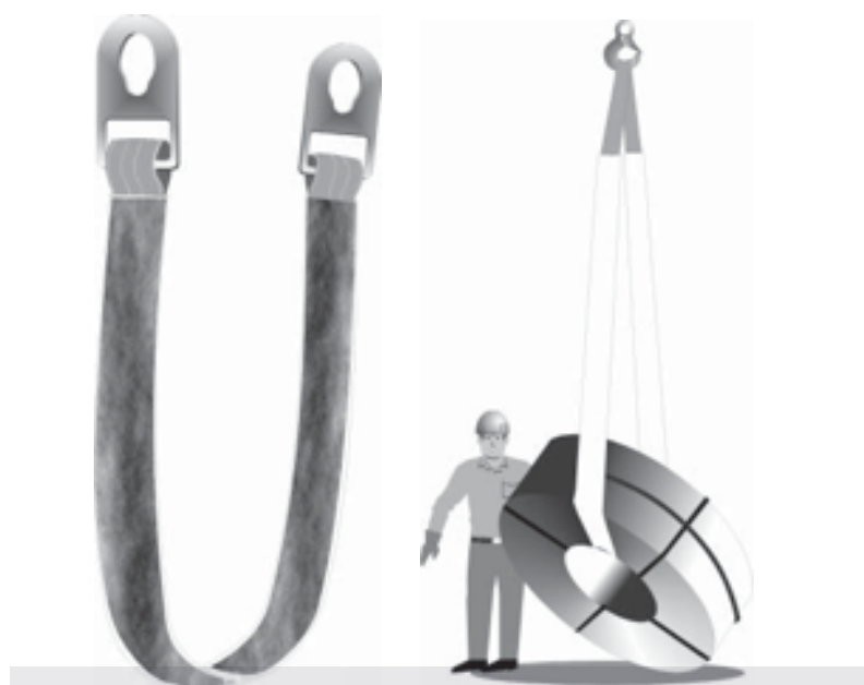
Figura 37 1) Cinta de poliéster para elevação de cargas. 2) Cinta movimentando bobina com proteção para canto vivo
