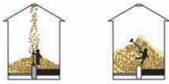
Figura 67 Carregamento de silos com trabalhadores em seu interior causando asfixia
