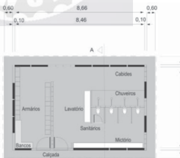
Figura 99 Sugestão de instalações sanitárias para 40 funcionários (medidas em metros)
