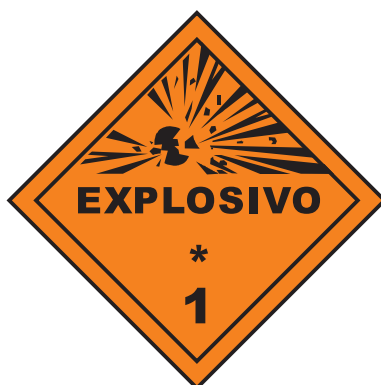
Figura 108 Exemplo de rotulagem para produtos explosivos. Os asteriscos são para os riscos subsidiários ou subclasses
