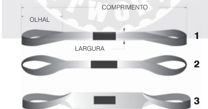
Figura 36 1) Olhal normal ( Basket ); 2) Olhal torcido ( Choker ); e 3) Olhal reduzido (ganchos pequenos)
