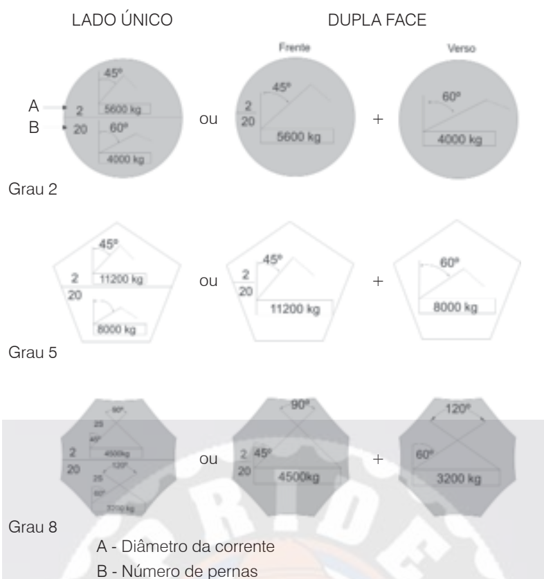
Figura 32 Plaquetas de identificação para lingas de correntes, conforme DIN 685
